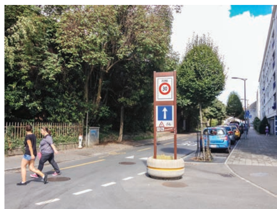
Illustration 16. Plus que de simples mesures de modération des vitesses, les zones 30 contribuent à la requalification des rues de quartier. L'aménagement de « portes » d'entrée signale le début de la zone.
